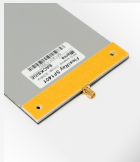
Konektor antény s montážními otvory a 3M páskou
